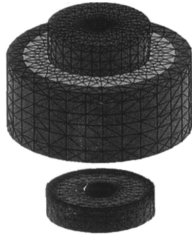
图 2 铝电解槽模型的网格划分图 Fig. 2 Sketch of mesh of aluminum reduction cell model
